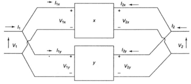
$$I_{1X} = Y_{11X} V_{1X} + Y_{12X} V_{2X}$$
